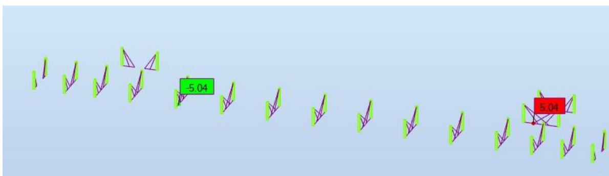
Figura 16 – Momentos fletores; coluna guarda-corpo
