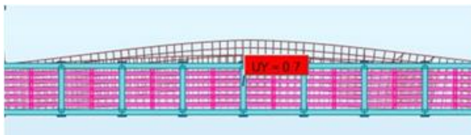
Figura 10 – deformações horizontais máximas - caso crítico
